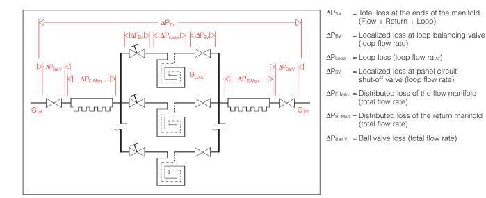
$$\Delta P_{\text{Tot.}} = \Delta P_{\text{BV}} + \Delta P_{\text{Loop}} + \Delta P_{\text{SV}} + \Delta P_{\text{F}} M_{\text{an.}} + \Delta P_{\text{R}} M_{\text{an.}} + \Delta P_{\text{Ball V}} \times 2$$
