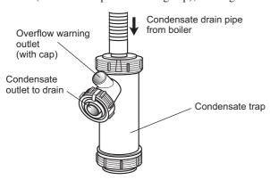
Fig. 14 - Condensate trap
